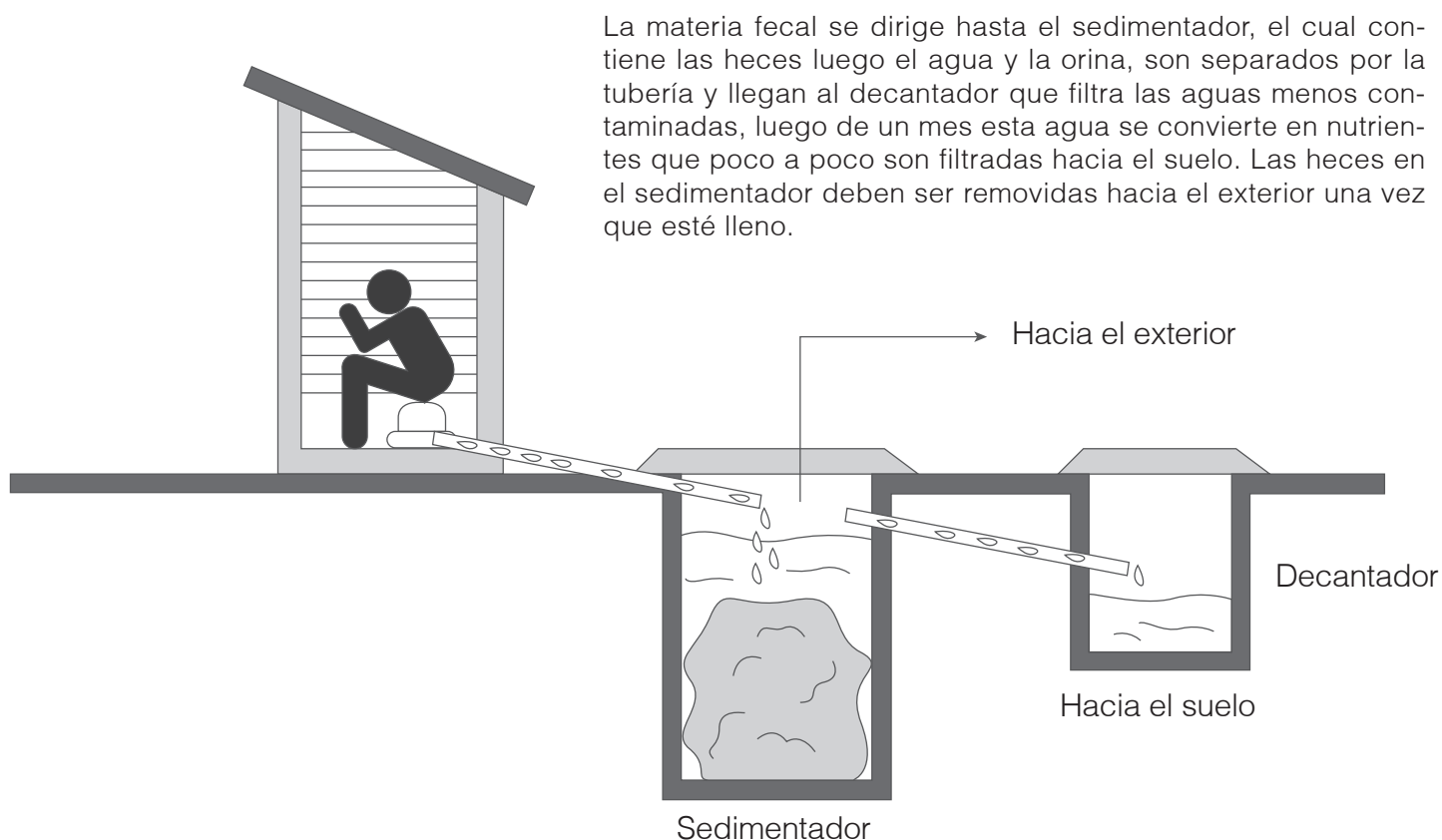
Figura 19. Funcionamiento de letrina en fosa séptica
